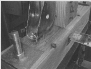
写真 3.5.3 試験体破壊部(最終時)
