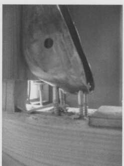
写真 3.2.3 試験体破壊部 (最終時)
