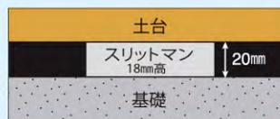
・パッキン工法に「33mm高タイプ」を組み合わせる場合、コンクリート基礎をあと15mm切り欠きます。
