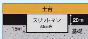
・基礎に直接土台をのせる工法の場合、基礎に20mmまたは35mmのスタイロを入れてコンクリートを打ちます。
