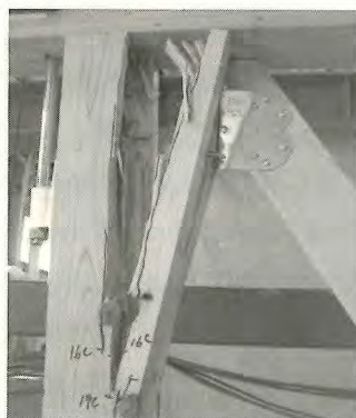
写真 2.5.2 試験体 C1 の破壊 3)
