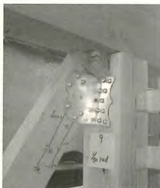
写真 2.5.2 試験体 C1 の破壊 3)
