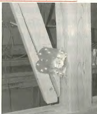
写真 2.5.1 試験体 A1 の破壊
