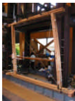
写真 4.4.3 実験供試体（最大変形時）
