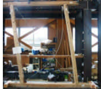
写真 4.3.2 実験供試体（最大変形時）
