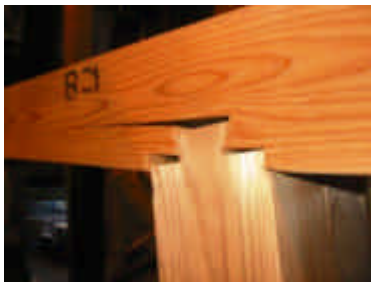
写真 4.6.5 上部材の割れ（最大変形時）
