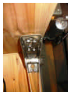
写真 4.4.4 左下接合部（最大変形時）
