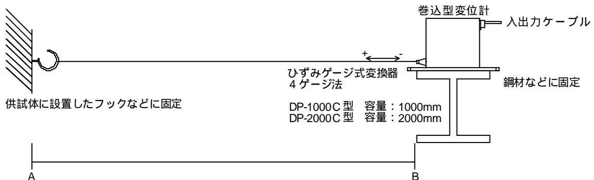
図 1.5.2 高感度変位計設置の方法と計測概要
