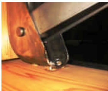
写真 4.5.5 金物ビスの抜け（最大変形時）
