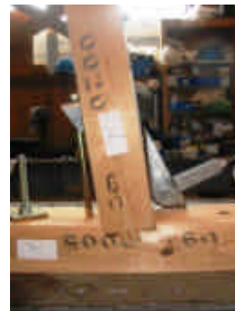
写真 4.5.4 左下接合部（最大変形時）
