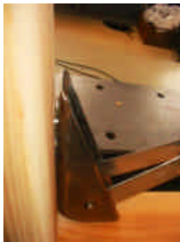
写真 4.3.5 金物ビスの引き抜け（最大変形時）
