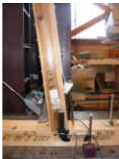
写真 4.5.3 右下接合部（最大変形時）
