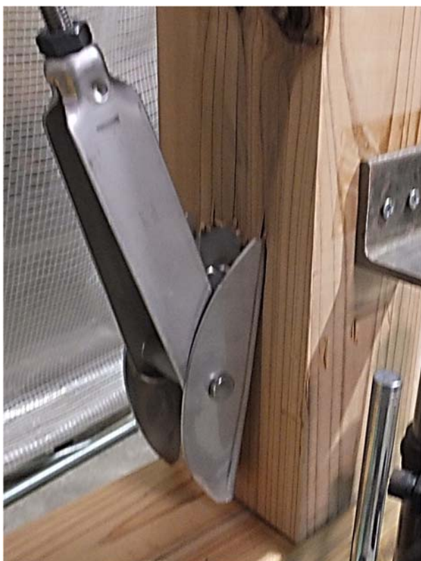
3. 柱脚部破壊状況
