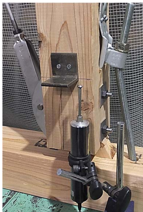
4. 終局時(1/15rad)の柱脚部状況 (角座金側)
