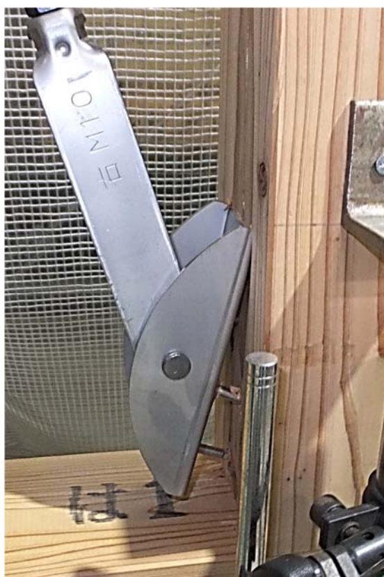
3. 柱脚部破壊状況
