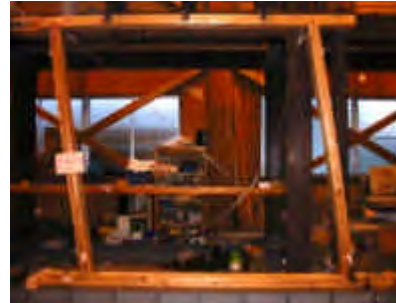
写真 4.6.2 実験供試体（最大変形時）
