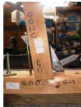
写真 4.5.4 左下接合部（最大変形時）
