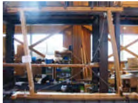
写真 4.5.2 実験供試体（最大変形時）
