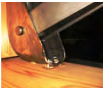
写真 4.5.5 金物ビスの抜け（最大変形時）
