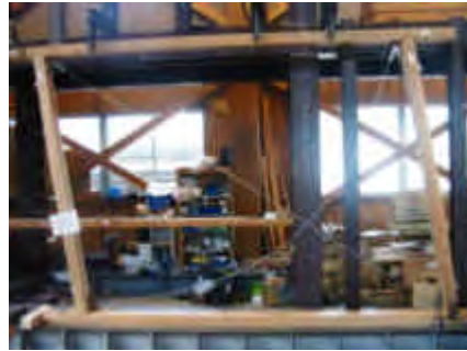
写真 4.7.2 実験供試体（最大変形時）
