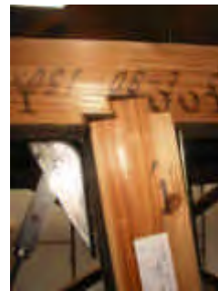
写真 4.7.4 右上接合部（最大変形時）
